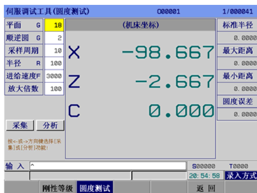
图 3-3-5-2-2 圆度测试界面
